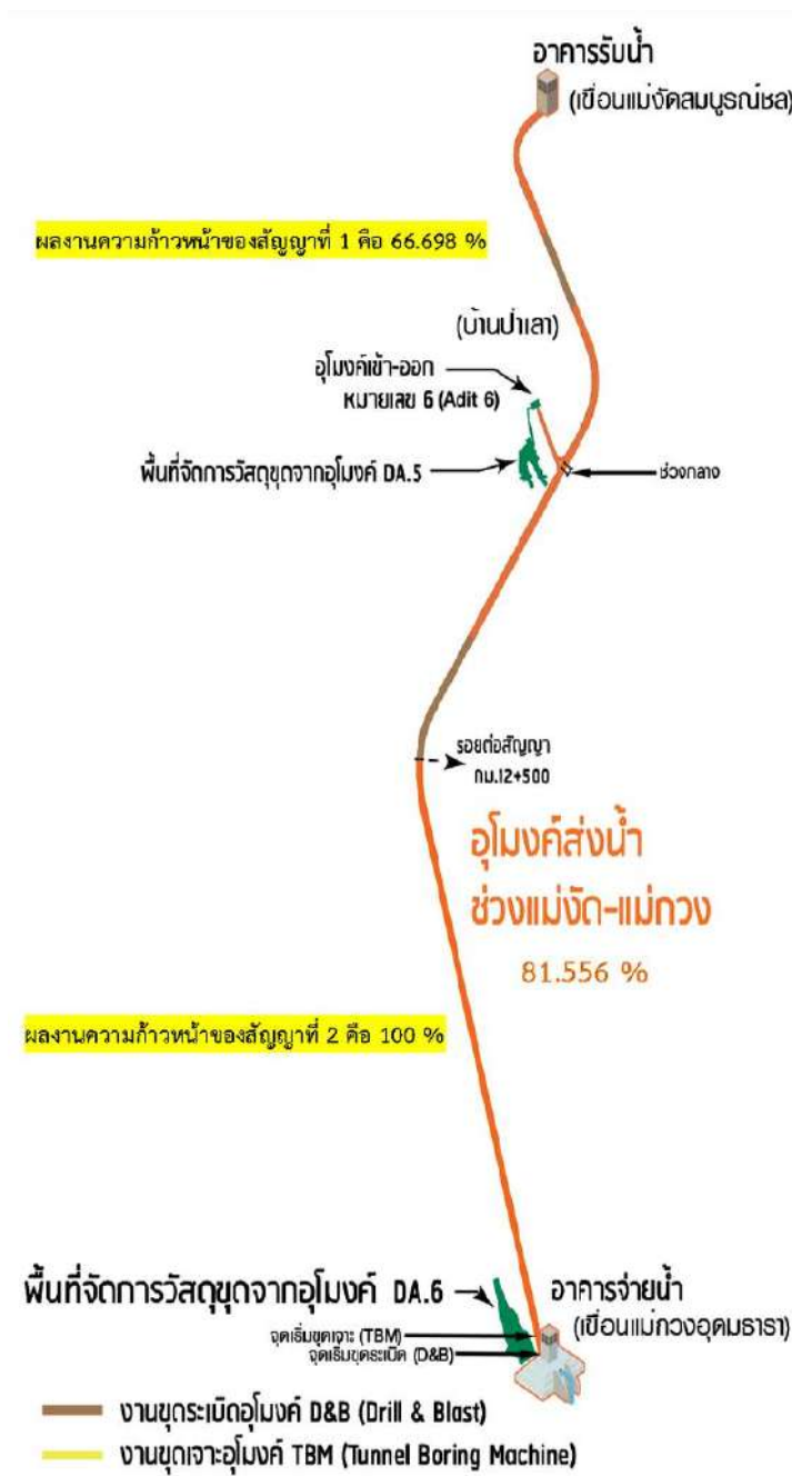
รูปที่ 1-2 ความก้าวหน้างานก่อสร้างอุโมงค์ส่งน้ำช่วงแม่จัต – แม่ทอง
