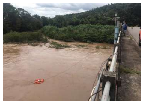
รูปที่ 5.9-6 ทำการสำรวจปริมาณน้ำและการสำรวจตะกอนแขวนลอยสถานี P.92A น้ำแม่แตง บ้านห้วยป่าซาง อำเภอแม่แตง จังหวัดเชียงใหม่
