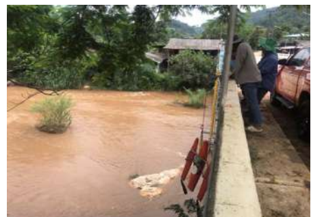
รูปที่ 5.9-4 ทำการสำรวจปริมาณน้ำและการสำรวจตะกอนแขวนลอยสถานี P.92 น้ำแม่แตง บ้านเมืองกีด อำเภอแม่แตง จังหวัดเชียงใหม่
